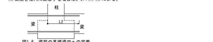
図1.6 梁筋の基礎梁内への定着
