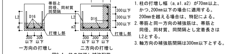
図2.4 柱の打増し補強配筋
