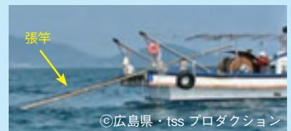
船から網を海底に下ろします。張竿とよばれる漁具で網口を広げ、網が海底に着いたらロープを一定の長さにし、潮流と同じ方向に網をひきます。
