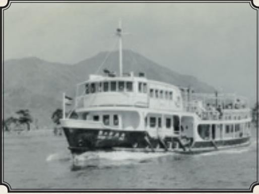
第二中央丸は昭和28年、松浦鉄工造船で建造されました。速力をはじめとした性能も高く、瀬戸内海の島々を巡る巡航船としては、先月掲載の第二和加丸とともに、ほぼ完成型といえる船で、船型もよく似ています。
